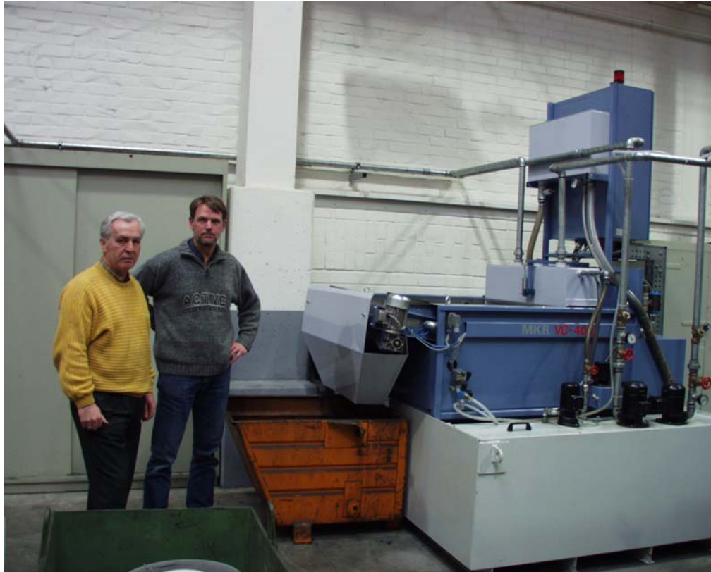
Foto 1 (030207-07-flender.jpg) Herbert Tenhofen (li) und Albert Eringfeld (re) sind mit den Vakuum-Bandfilter-Geräten von MKR sehr zufrieden: Sie haben eine sichere Entsorgung und sparen noch dazu Kosten.
