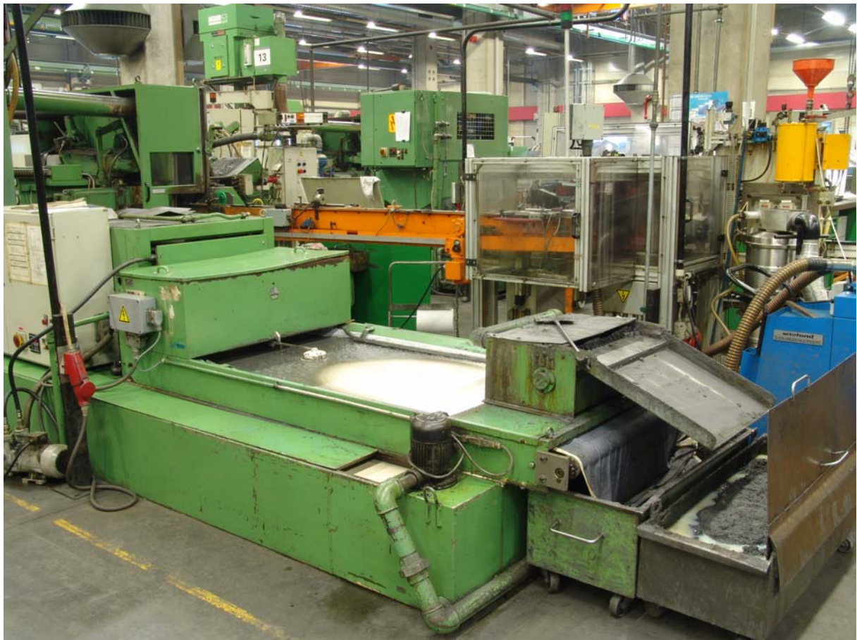
Foto 4 (050301-11) Gehört bald der Vergangenheit an: Früher wurde der feuchten Schlamm – und beim Flachbettfilter auch noch das Papier – teuer als Sondermüll entsorgt.
