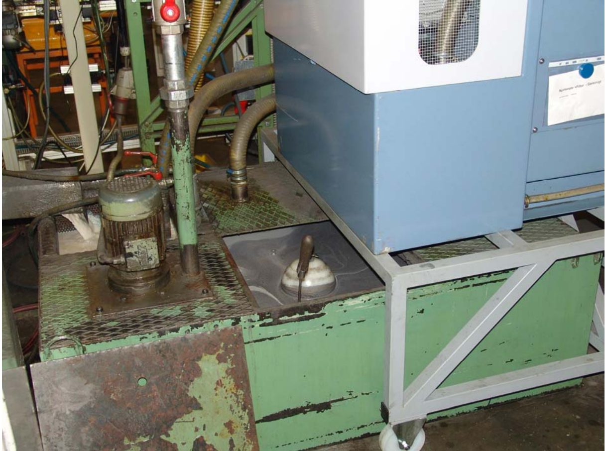
Foto 2 (050224-08) Kein Schlamm mehr im KSS-Behälter: Die MKR-VC-Filteranlage saugt den KSS an, reinigt und pumpt ihn wieder zurück in den Behälter.
