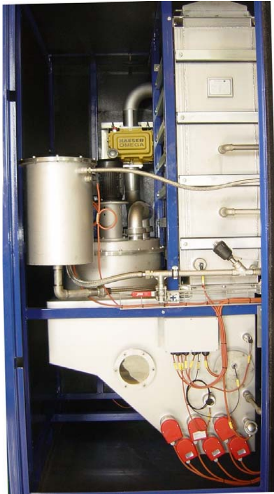
Foto 2 (DSC 01998-2) Ein Blick hinter die Kulisse der Blechverkleidung zeigt den Prozessbehälter und den Wärmetauscher. Bild: MKR
