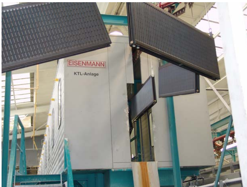
Foto 6 (050916-16) Das ist der Beweis für die gute Vorbehandlung: Die Heizkörper schimmern bläulich-lila, wenn sie in die KTL-Anlage einfahren.
